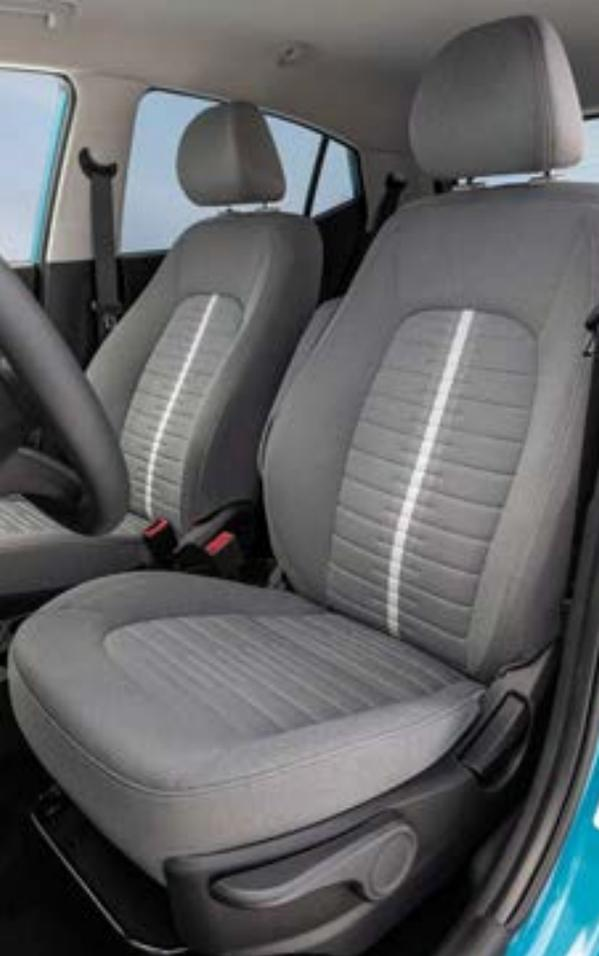
У рулевой колонки изменяется только угол наклона, зато можно отрегулировать высоту водительского сиденья. Сама посадка за рулем достаточно высокая, что в купе с тоненькими стойками крыши и пониженной оконной линией улучшило обзорность. Сиденья i10 мягкие и комфортабельные, хотя немного больше боковой поддержки им не помешало бы.
