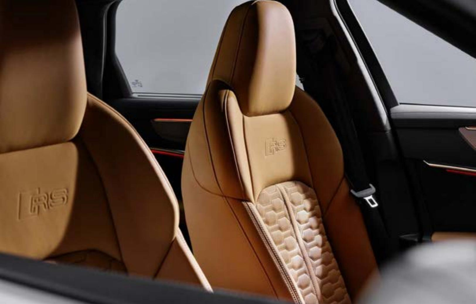
ками. У них отличная боковая поддержка и комфорт на высоте. Кресла оснащены электроприводом и подогревом, а за доплату доступны вентиляция и массаж. Посадка за рулем низкая, а водителя и пассажира разделяет высокий трансмиссионный тоннель. Установленный на нем подлокотник прячет бокс с беспроводной зарядкой для смартфонов.
