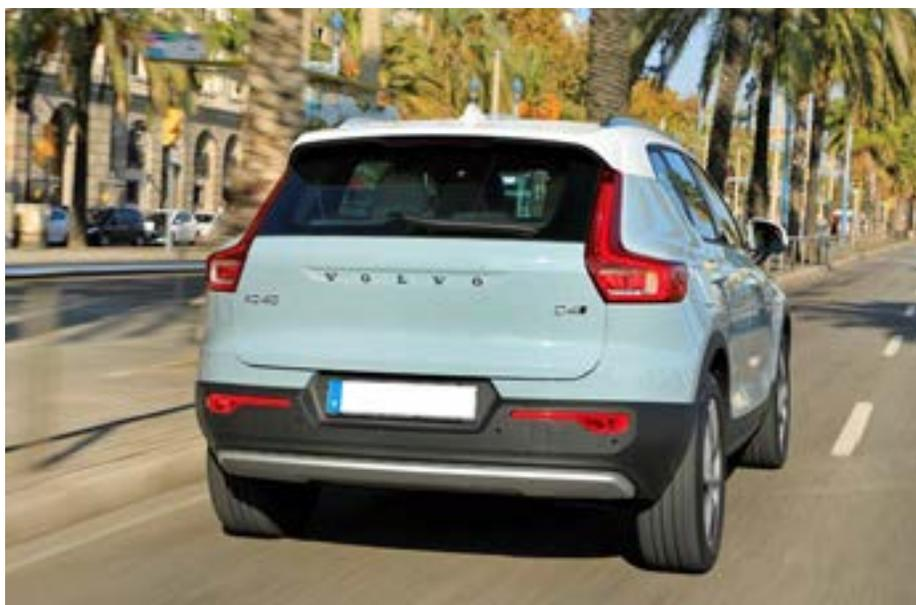
**L-образные фонари XC40 размещены в стойках крыши**
