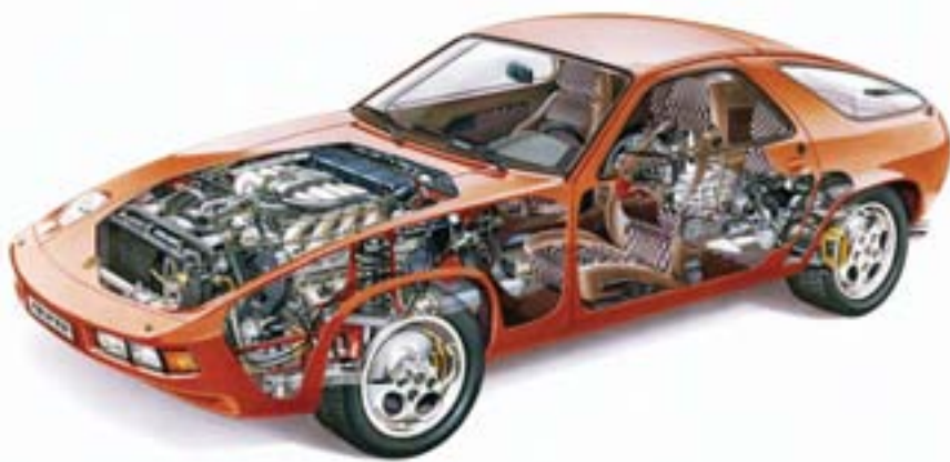
Компоновка transaxle подразумевает двигатель спереди, а трансмиссию — у задней оси
