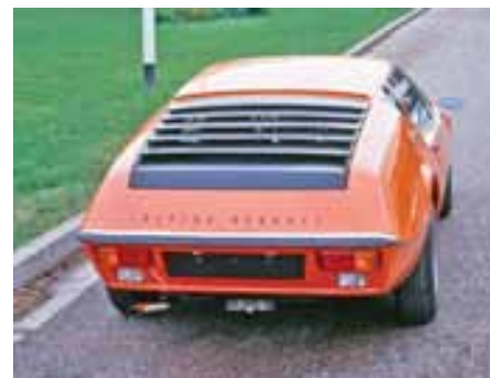
A310 сохранил заднемоторную компоновку
