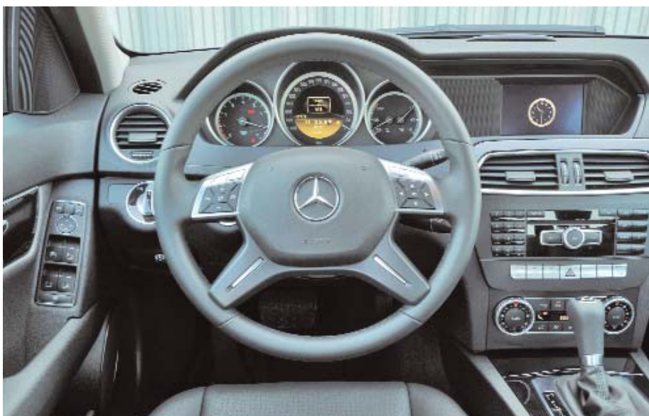
Приборы Mercedes-Benz установлены в трех отдельных колодцах
