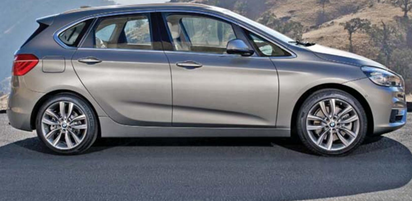
BMW 2 Series Active Tourer – еще и первый автомобиль немецкой марки с передним приводом. Платформу для него позаимствовали у нового Mini. Он достигает 4323 мм в длину при колесной базе в 2670 мм. Мини-вэн достаточно широкий (1800 мм) и высокий – 1555 мм. В целях снижения массы капот изготовлен из алюминиевых сплавов. Начальный вариант весит 1395 кг.
