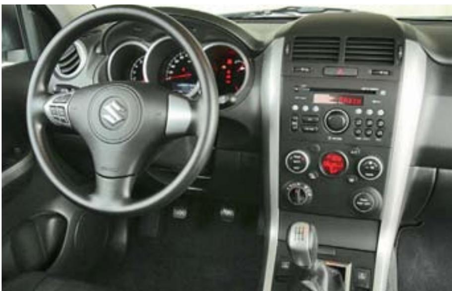
Циферблаты приборов Suzuki размещены в трех отдельных колодцах
