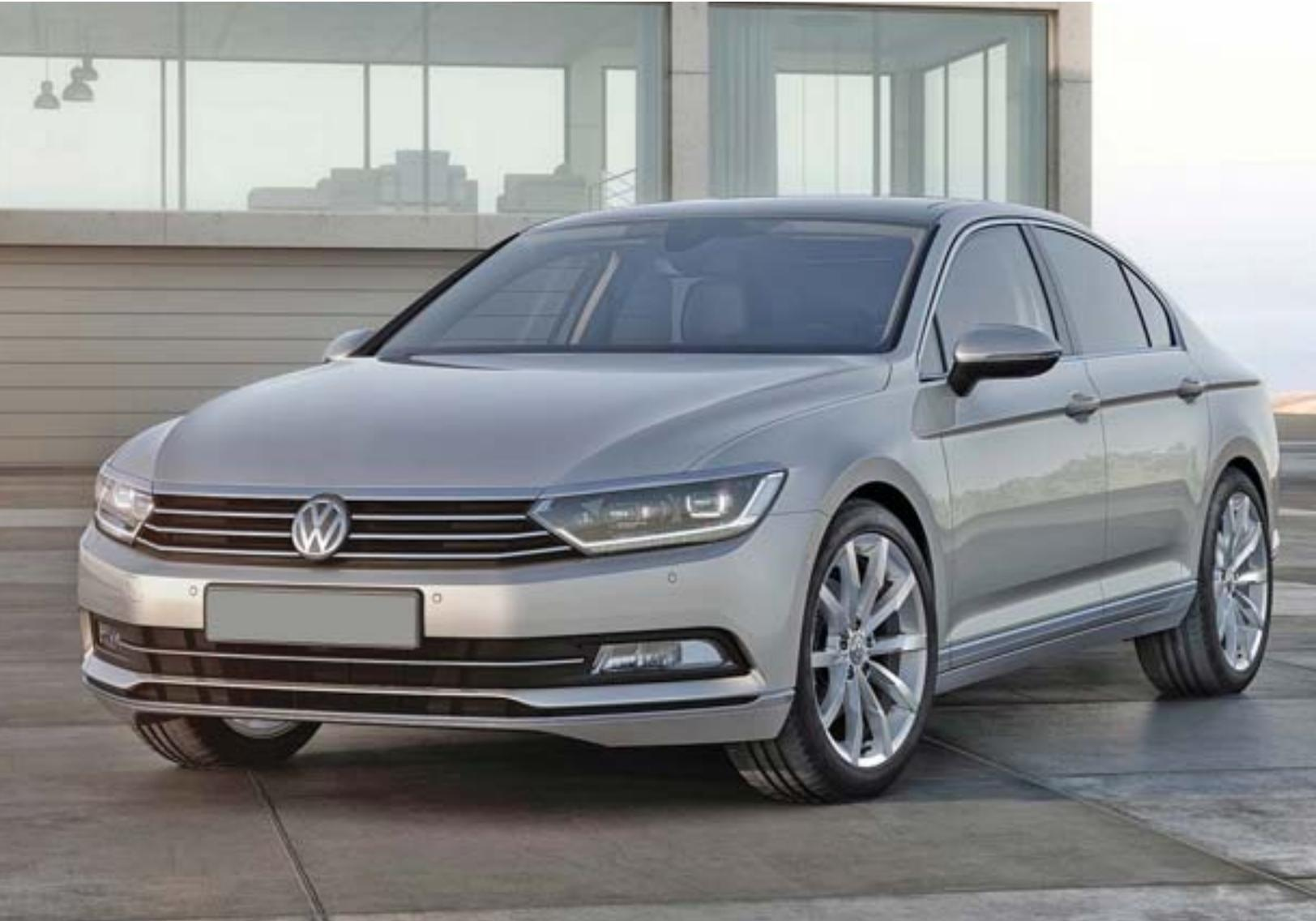
Седан и универсал построены на удлиненной платформе MQB, которую использует младший брат Golf. Интересно, что четырехдверная модель даже немного короче предшественника – 4767 мм. Колесная база при этом выросла на 79 мм – до 2791 мм. Passat B8 на 12 мм шире (1832 мм) и на 14 мм ниже (1456 мм). Масса при этом снижена на 85 кг – до 1312 кг в начальной версии.
