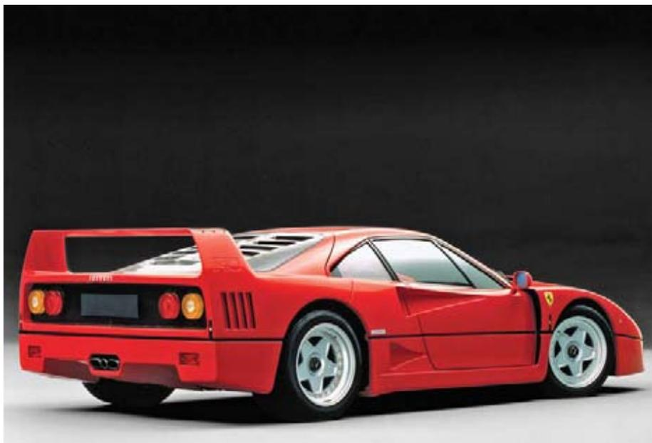
Антикрыло Ferrari F40 призвано обеспечить большую прижимную силу
