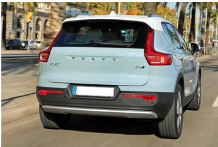
L-образные фонари XC40 размещены в стойках крыши
