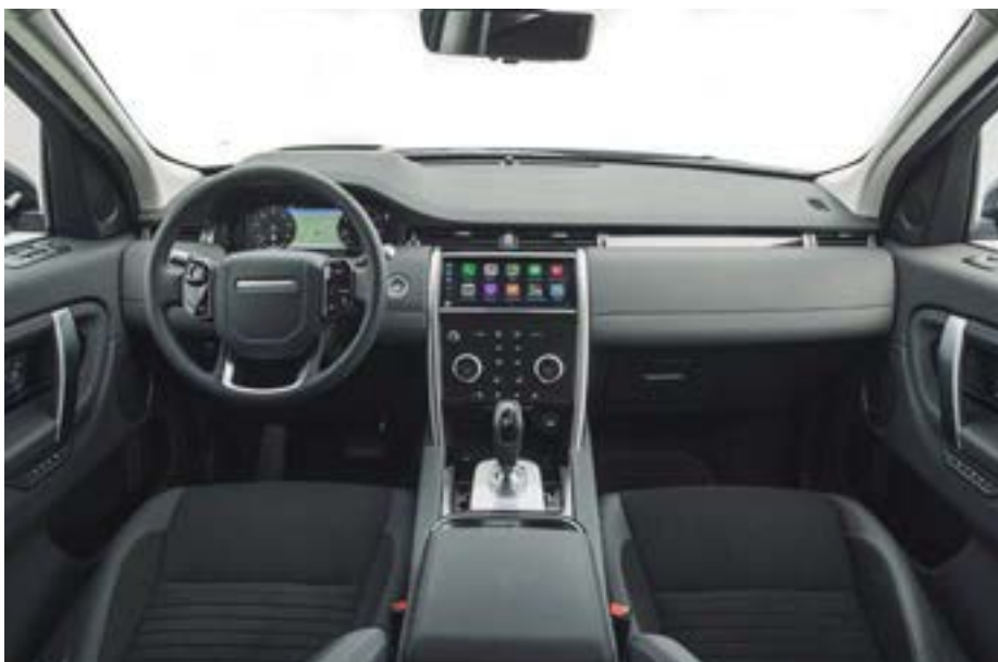
Приборная панель Land Rover – цифровая, а кнопки на центральной панели – сенсорные
