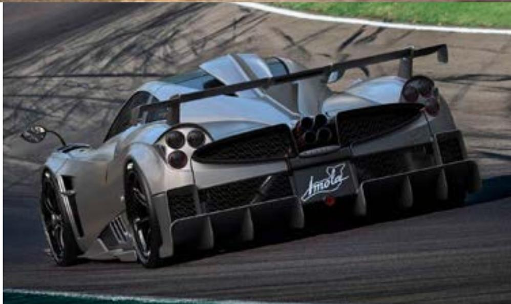
Внешние отличия призваны улучшить аэродинамику. Автомобиль получил огромное заднее антикрыло с килем, как у гоночных спортпрототипов. Также предусмотрен новый обвес. Прижимная сила при 280 км/ч превышает 500 кг.
