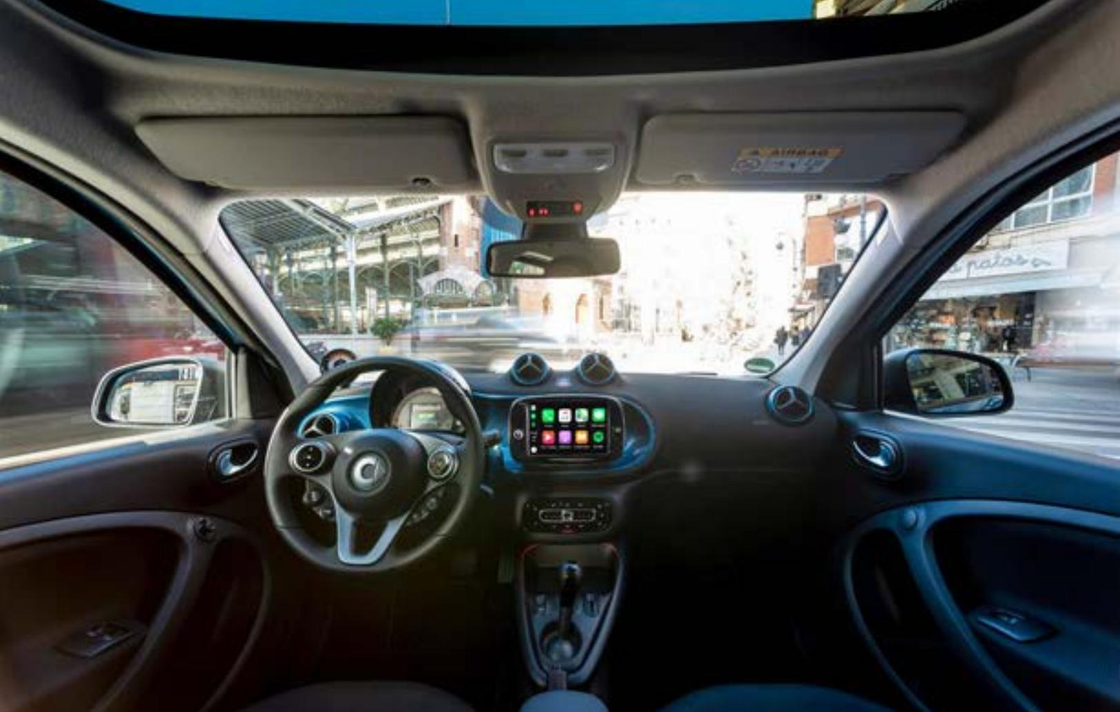
ра. Вместо тахометра сверху на передней панели – указатель заряда батареи.
