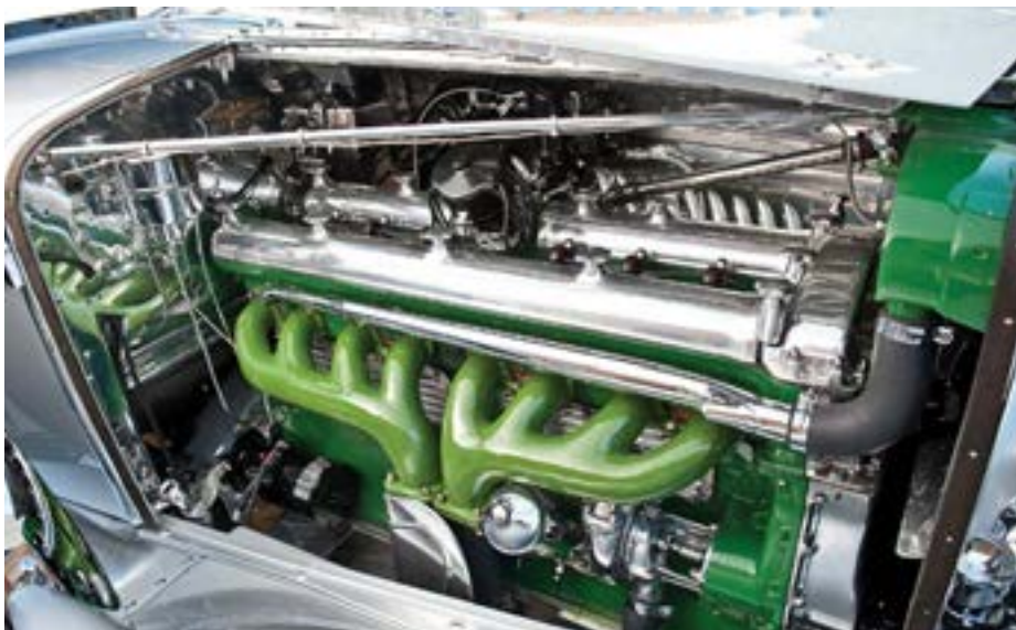
Рядная 6,9-литровая «восьмерка» развивала 265 л. с. в атмосферной версии и 320-400 л. с. – с компрессором
