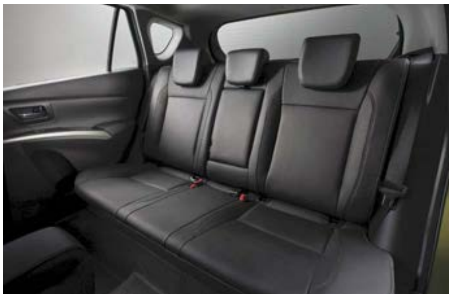
Задние сиденья SX4 получили горизонтальную регулировку
