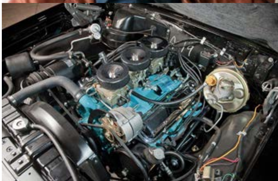
С помощью трех двухкамерных карбюраторов мощность 6,4-литрового мотора подняли до 348 л. с.
