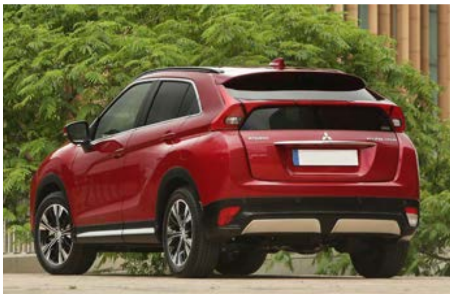
Заднее стекло Eclipse Cross состоит из двух секций
