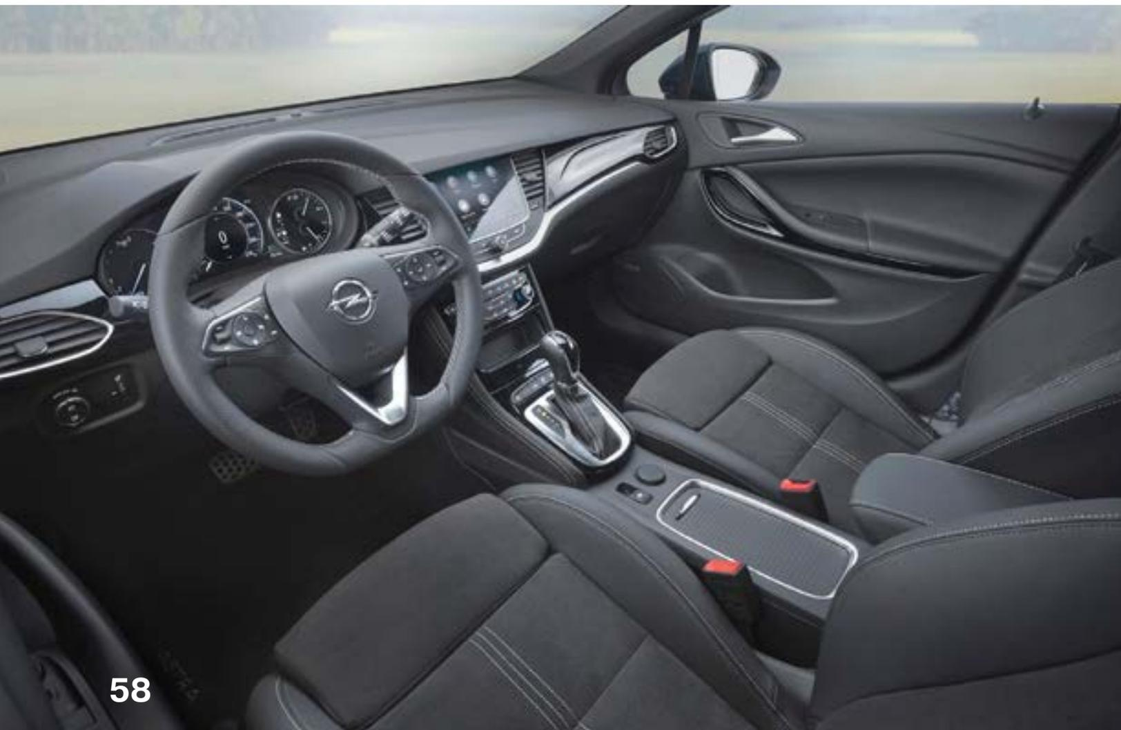
заменены. За доплату теперь доступна цифровая панель приборов. Наклоненную центральную консоль венчает 8-дюймовый сенсорный дисплей новой мультимедийной системы IntelliLink. Список опций пополнили беспроводная зарядка для смартфонов, подогрев лобового стекла и мощная ауди-
