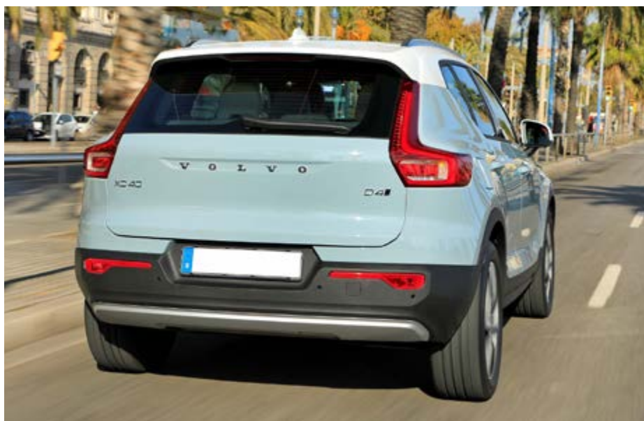
L-образные фонари XC40 размещены в стойках крыши
