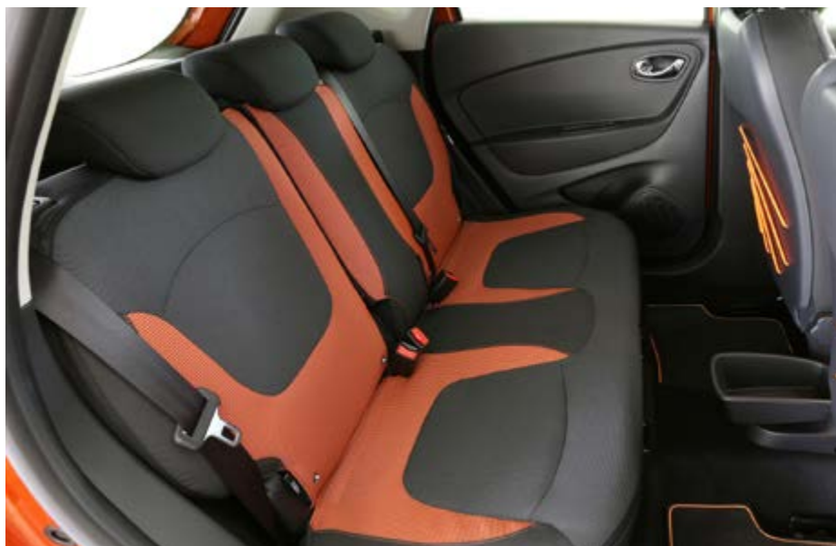
Задние сиденья Captur оснащены горизонтальной регулировкой
