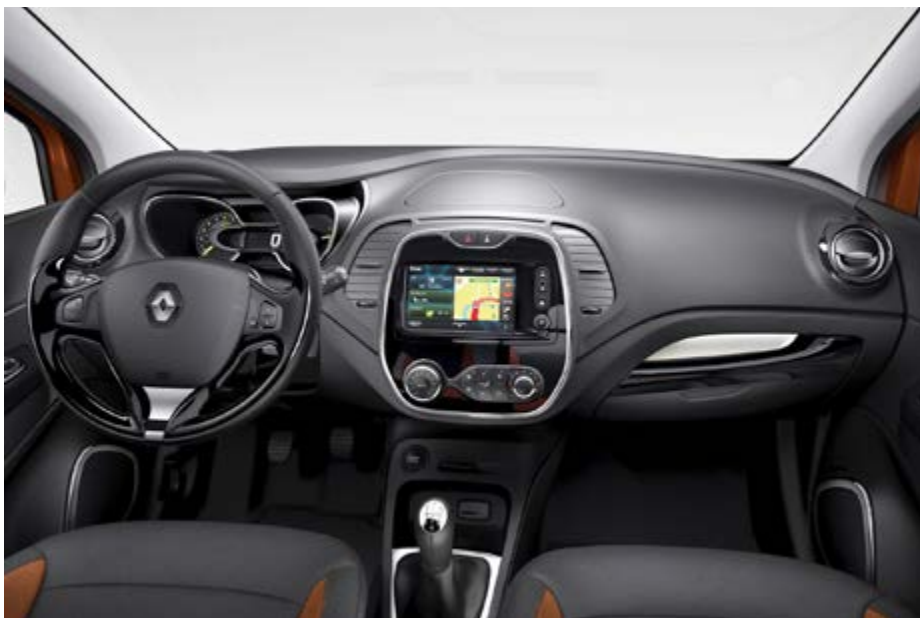
Цифровой спидометр Renault сочетается с аналоговым тахометром
