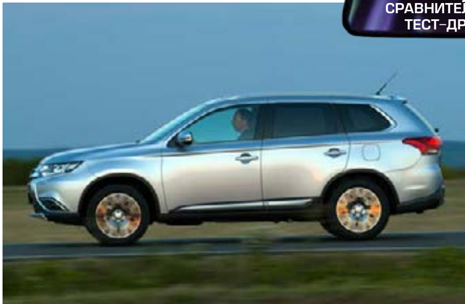
Стойки крыши Outlander имеют малый угол наклона
