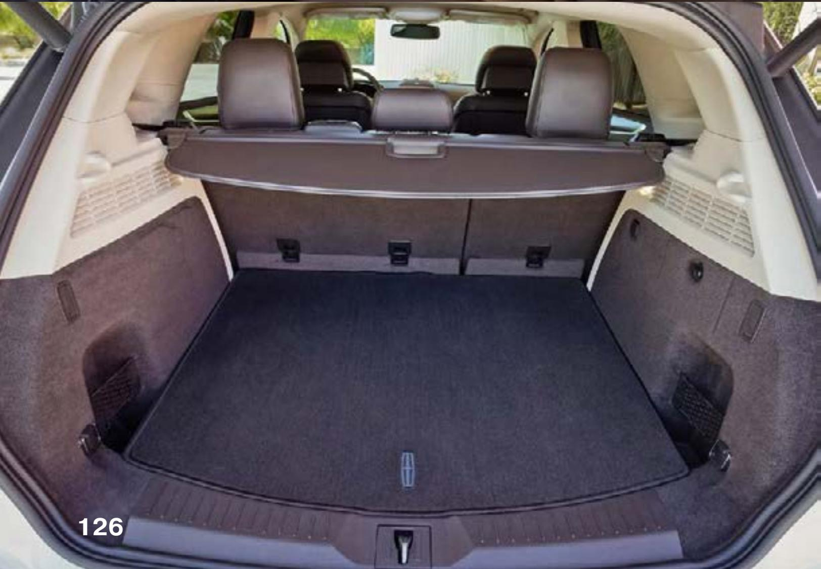
комфортнее двоим сидокам, но при надобности поместятся и трое. Объем багажника составляет 508 л в обычном состоянии, а сложенными задними креслами возрастает до 1503 л. Пятая дверь оснащена электроприводом с сенсором открытия, реагирующим на движение ноги под бампером.
