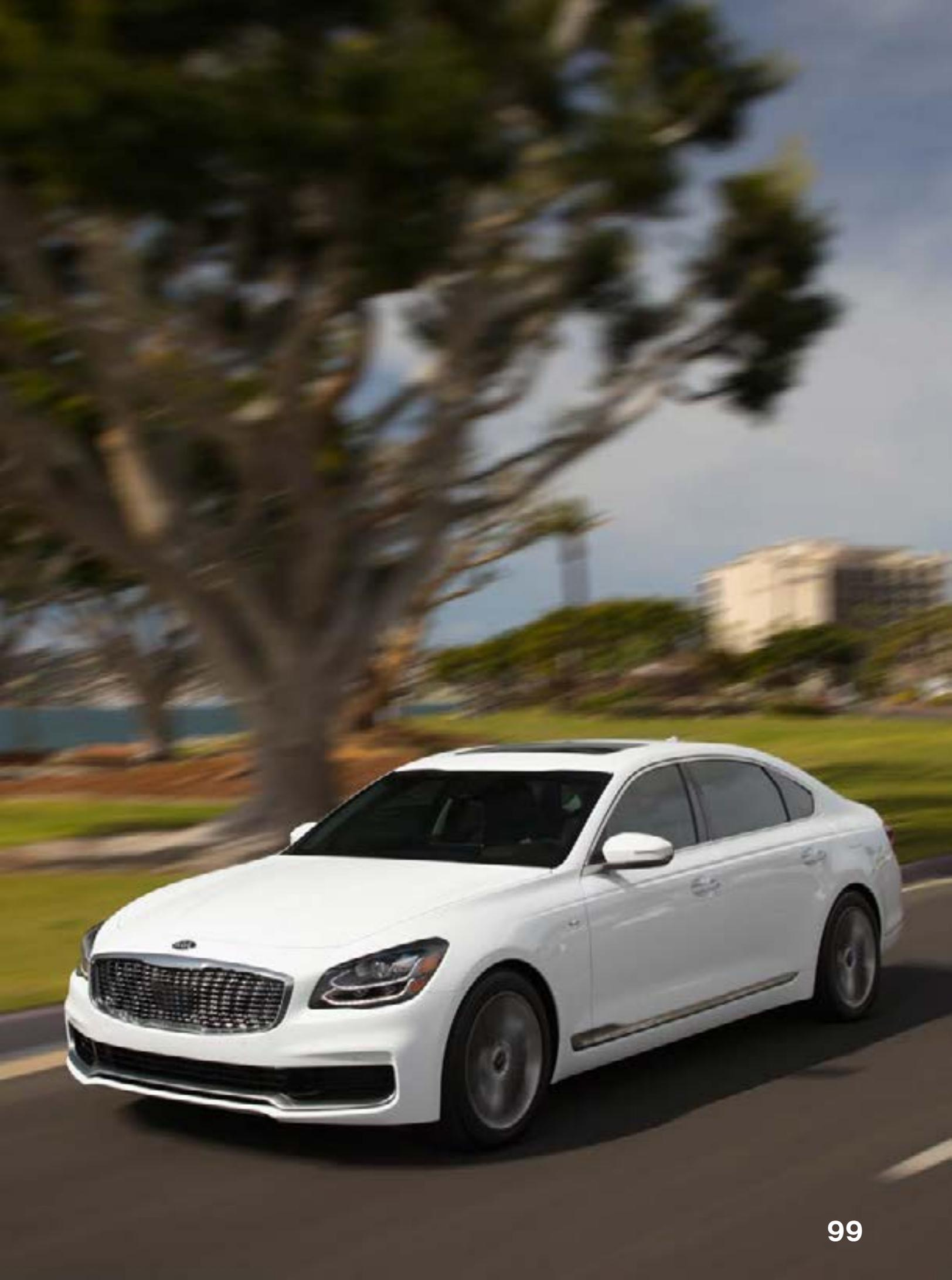
Поначалу представительский седан выйдет на глобальный рынок только с 3,3-литровым турбированным V6. Двигатель развивает 370 л. с. при 6000 об/мин. Турбопауза у нее почти отсутствует, а тяга на малых оборотах отличная, ведь максимальные 520 Н·м крутящего момента в распоряжении уже с 1300 об/мин. Мотор отзывчив и обеспечивает равномерный разгон, но при этом очень тихий. Kia K900 достигает 100 км/ч за 5,6 с, а его максимальная скорость ограничена на отметке в 240 км/ч. В городском
