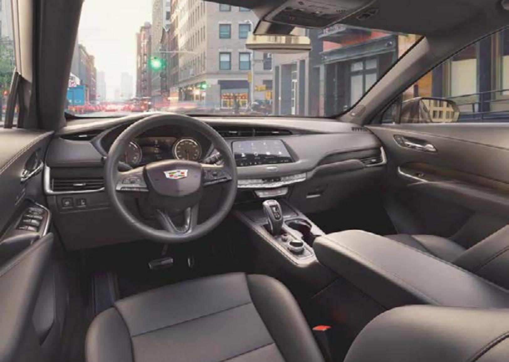
чана 8-дюймовым дисплеем мультимедийной системы CUE. Он сенсорный, но для навигации в меню есть и круглый джойстик. Переключатели блоков аудиосистемы и климат-контроля расположены в два ряда и довольно мелкие. Под ними размещена ниша для мелкой поклажи, которую за доплату можно дополнить беспроводной зарядкой для смартфонов. Также в салоне четыре USB-порта и три 12-вольтовые розетки.
