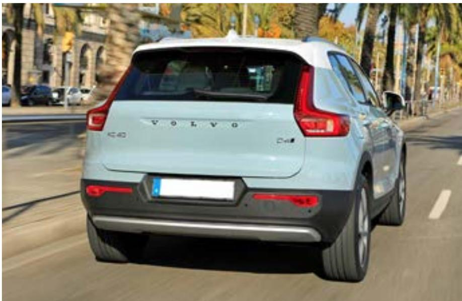
**L-образные фонари XC40 размещены в стойках крыши**
