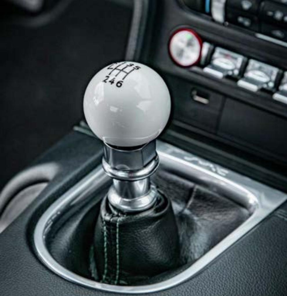
Bullitt доступен только с 6-ступенчатой механической трансмиссией. Она отличается точностью работы, а педаль сцепления довольно легкая.
