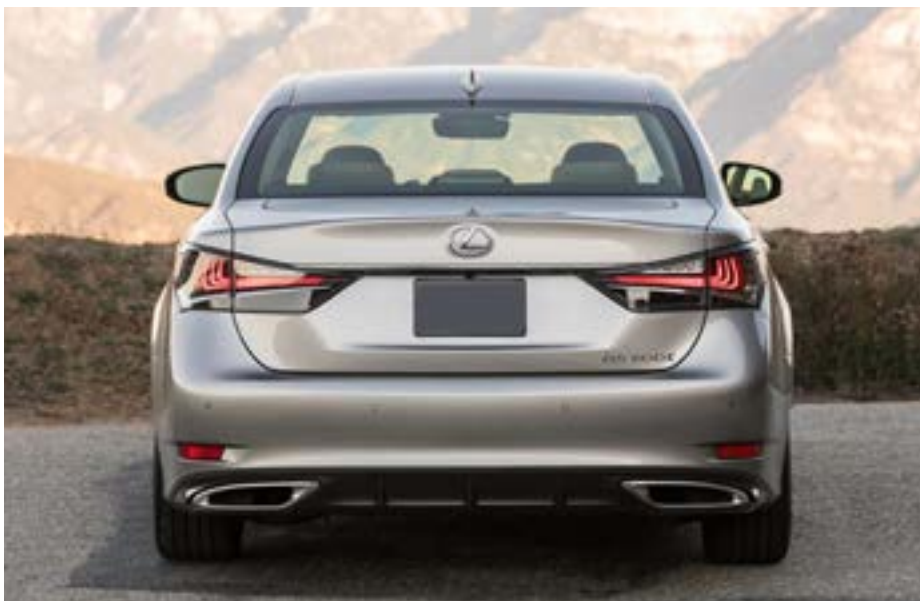
В фонарях Lexus размещены специальные наплывы, улучшающие аэродинамику
