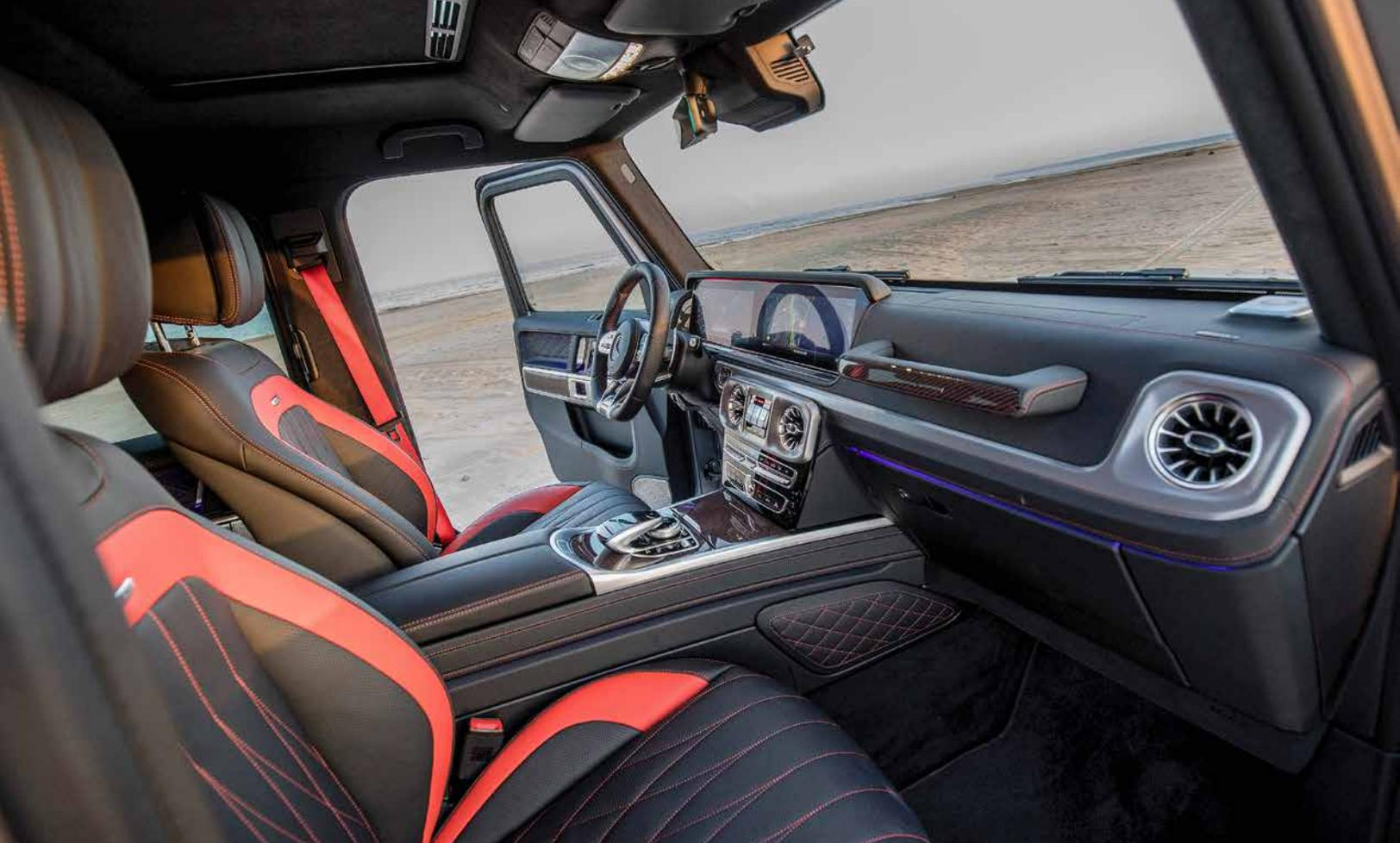
вый экран – он отвечает за мультимедийную систему и спутниковую навигацию. Наряду с клавишами блоков аудиосистемы и климат-контроля, здесь установлены три крупных кнопки выбора блокировок дифференциалов. Нашлось место и для небольшого циферблата часов. Со стороны пассажира
