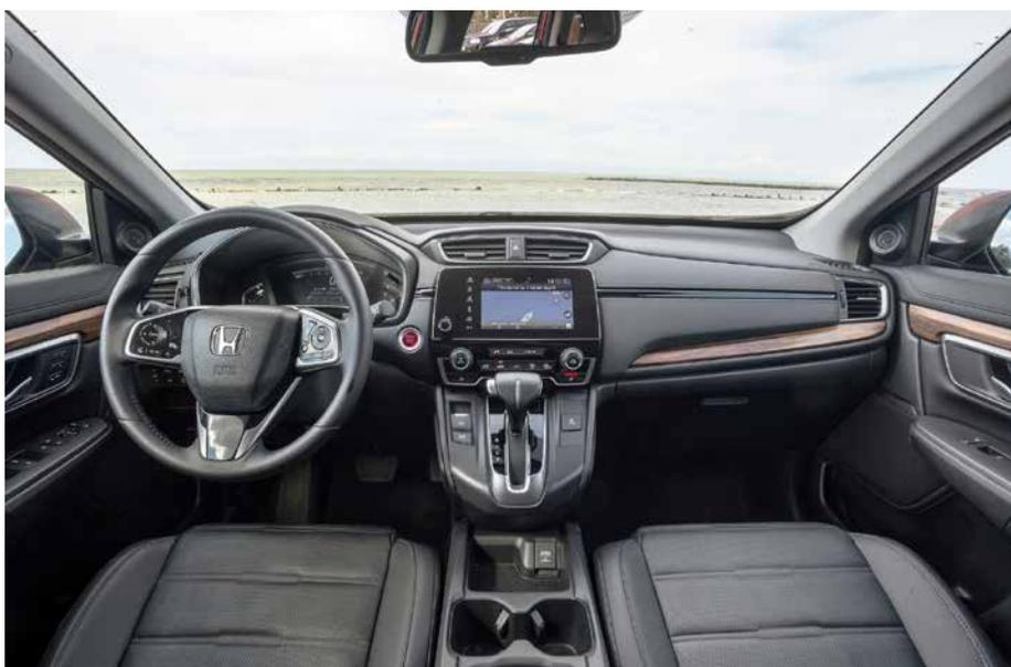
**Селектор трансмиссии Honda установлен высоко на центральной панели**
