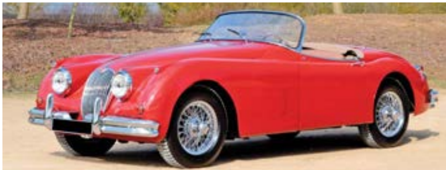
Jaguar XK150 S Roadster 1959 года оснащен 265-сильным мотором от гоночного D-Type
