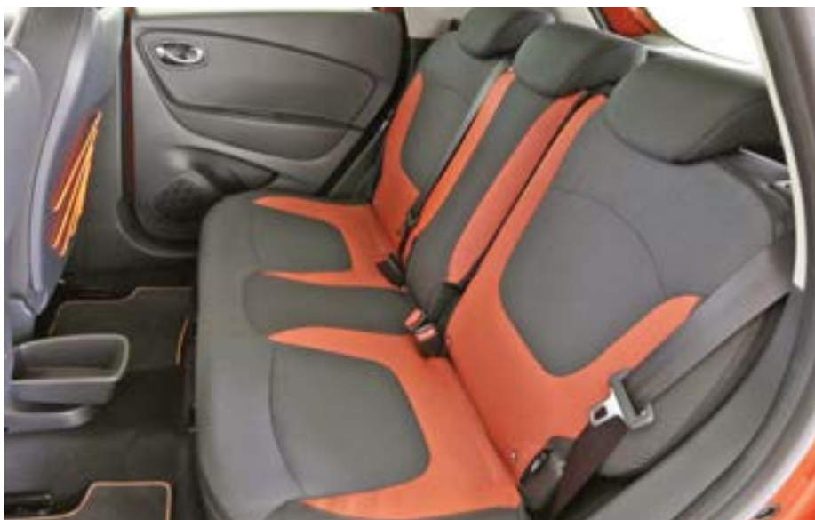
Задние сиденья Captur оснащены горизонтальной регулировкой
