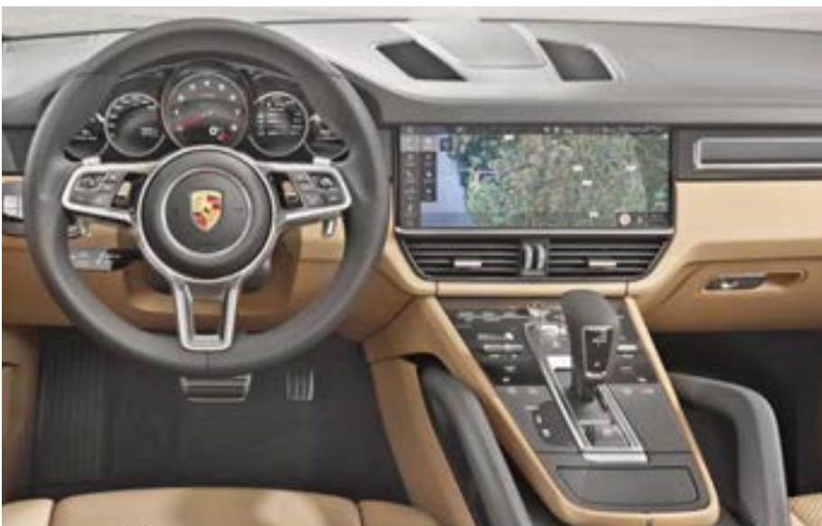
Спидометр на приборной панели Porsche с боков окружен двумя дисплеями
