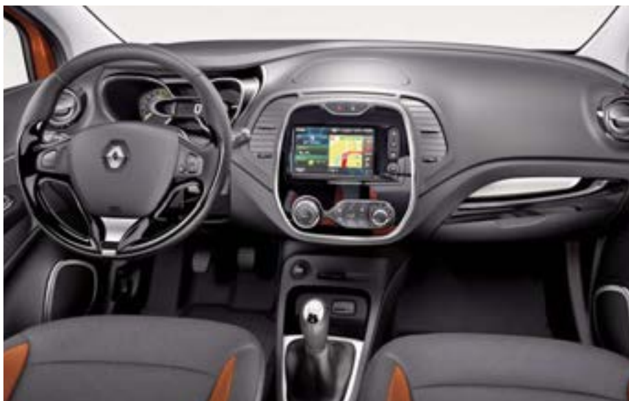
Цифровой спидометр Renault сочетается с аналоговым тахометром
