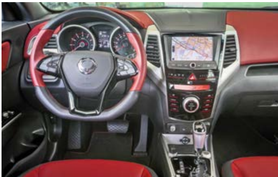
Приборы SsangYong помещены в отдельные колодцы
