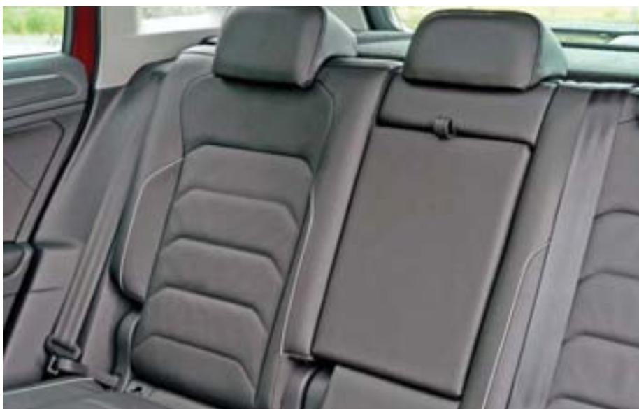
Задние сиденья Tiguan оснащены горизонтальной регулировкой
