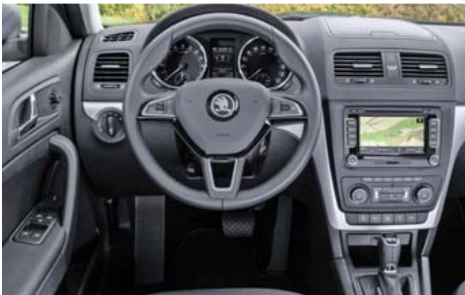
Циферблаты приборов Skoda помещены в отдельные колодцы
