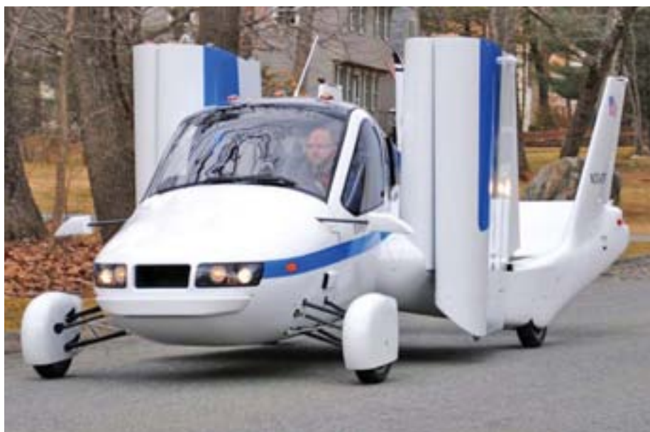
TerraFugia Transition оснащен складывающимися крыльями
