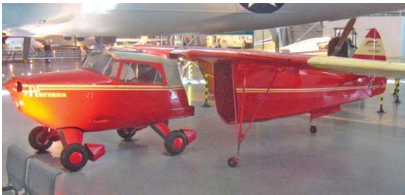
У Fulton FA-2 Airphibian отсоединялись крылья и хвост
