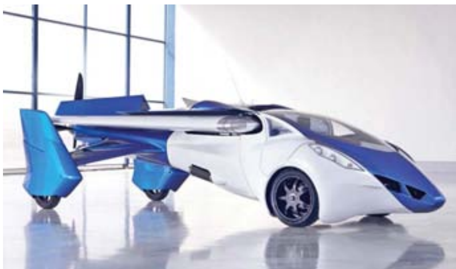
АeroMobil 3.0 оснащен складывающимися крыльями
