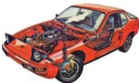
Компоновка transaxle подразумевала переднее расположение двигателя и трансмиссию в блоке с главной передачей у заднего моста
