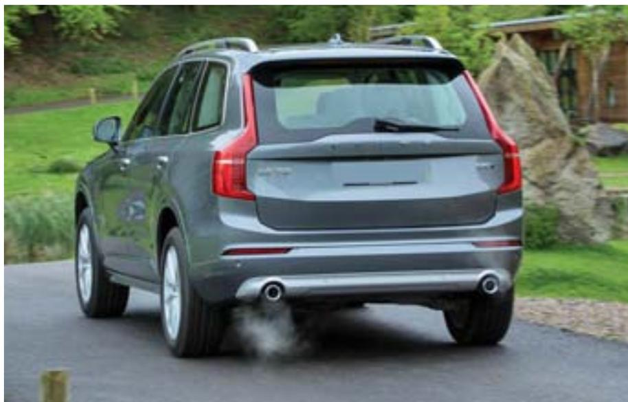
**Узкие фонари XC90 размещены в стойках крыши**
