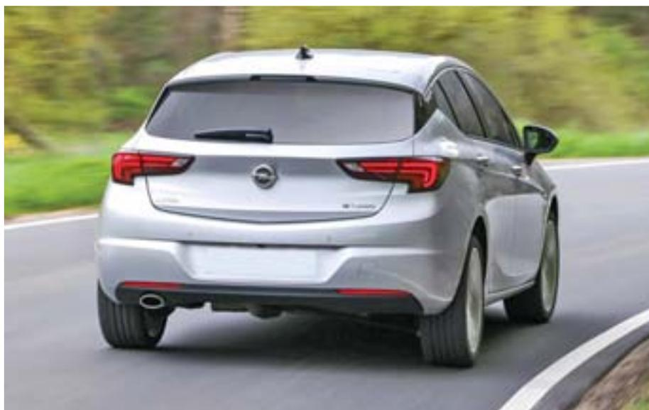
**По краям кузова Astra установлены Г-образные фонари**
