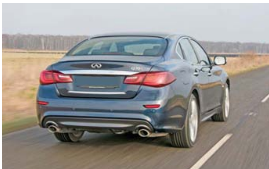
В крышку багажника Infiniti интегрирован спойлер
