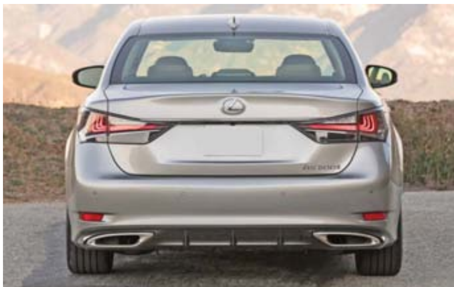
В фонарях Lexus размещены специальные напльвы, улучшающие аэродинамику
