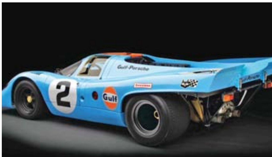
Обрезанная задняя часть позволила улучшить управляемость купе
