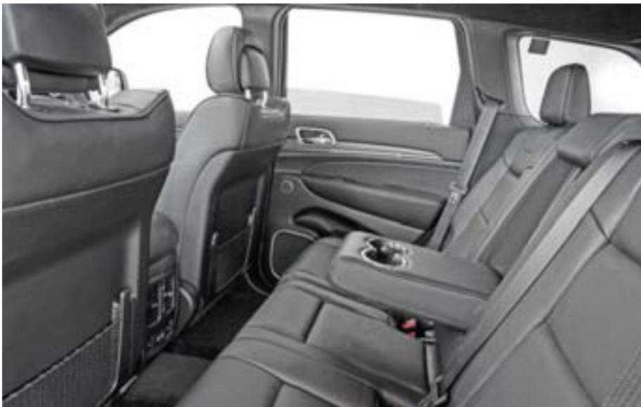
У задних сидений Jeep регулируется угол наклона спинки
