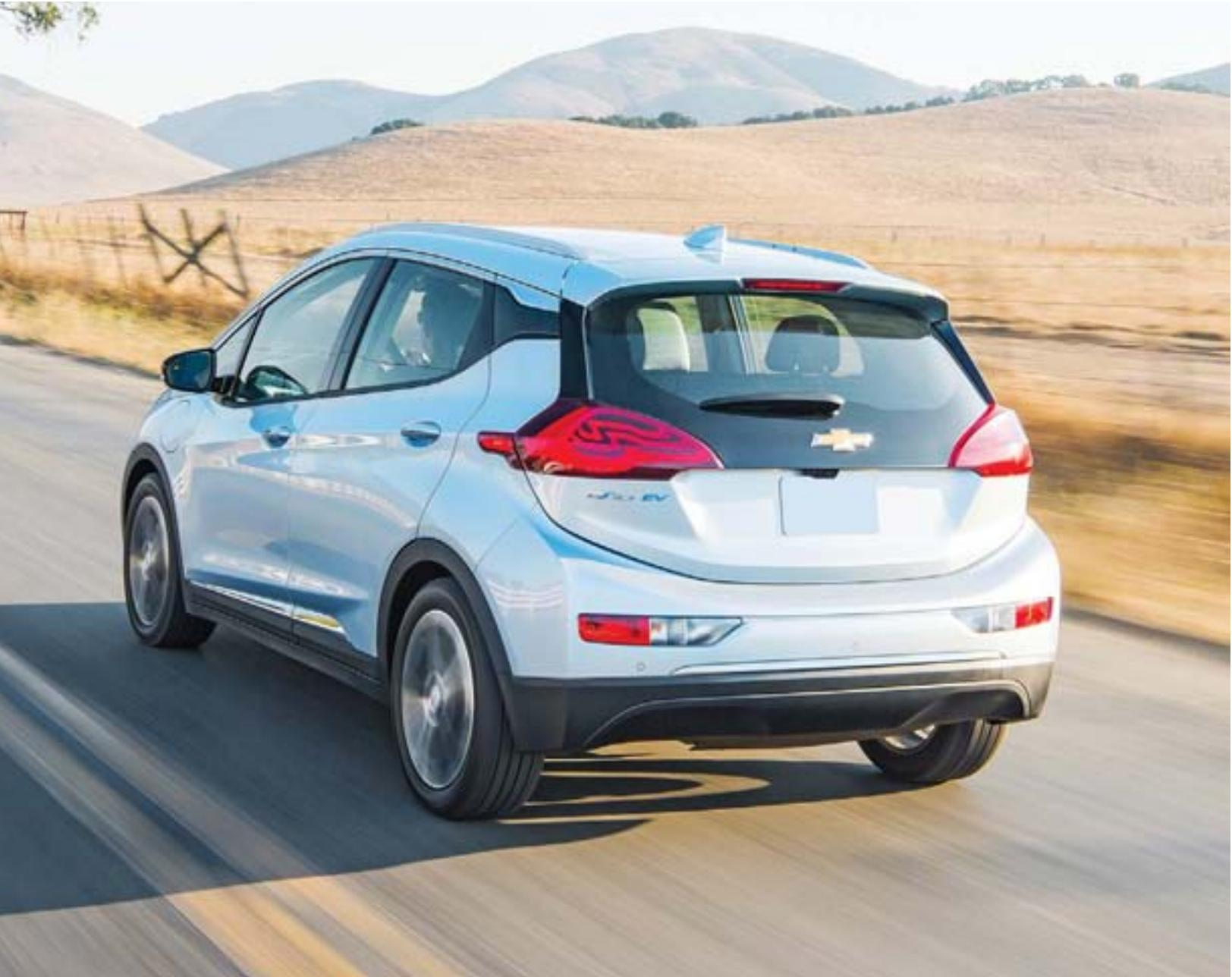
Электромобиль Chevrolet Bolt – небольшой мини-вэн длиной 4165 мм, шириной 1765 мм и высотой 1595 мм при колесной базе в 2600 мм. Платформу для него позаимствовали у Chevrolet Aveo. В целях экономии от легких алюминиевых сплавов отказались, а потому весит электромобиль немало – 1625 кг.
