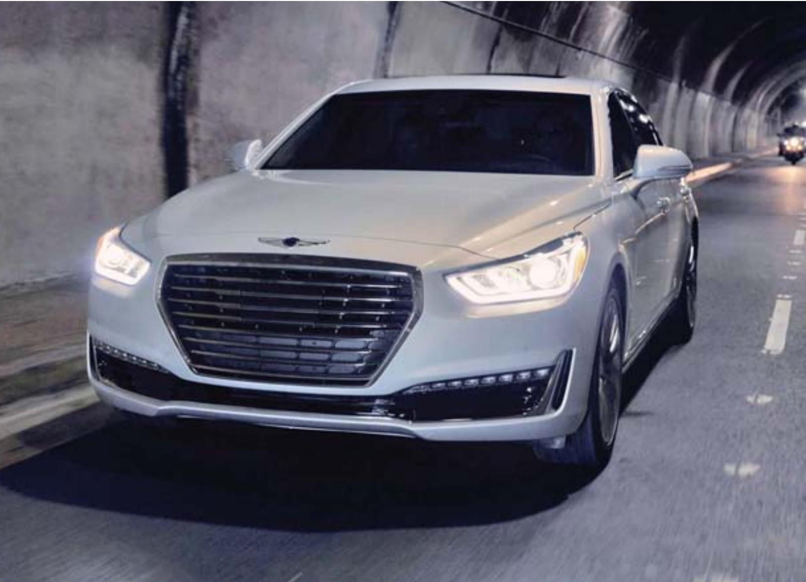
Hyundai Genesis G90 построен на полностью новой заднеприводной платформе, которая станет основой и для будущих моделей Genesis. Его колесная база на 115 мм больше, чем у предшественника – 3160 мм. Длина выросла до 5205 мм, ширина – до 1915 мм, а высота – до 1496 мм. Учитывая исполинские размеры седана, начальная масса в 2097 кг вполне объяснима.
