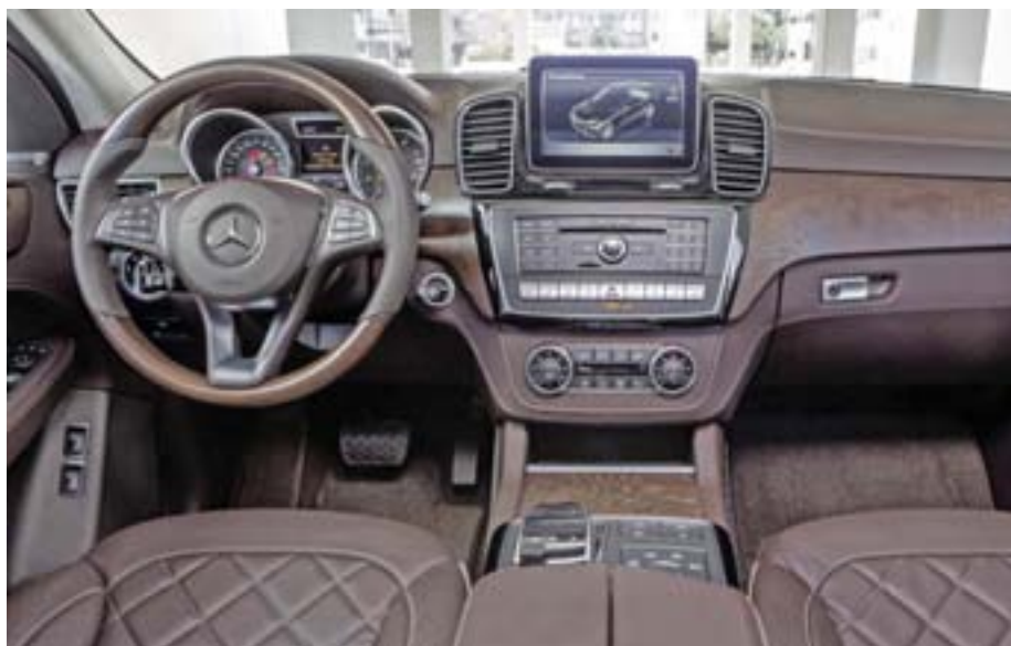
Циферблаты приборов Mercedes-Benz помещены в два отдельных колодца
