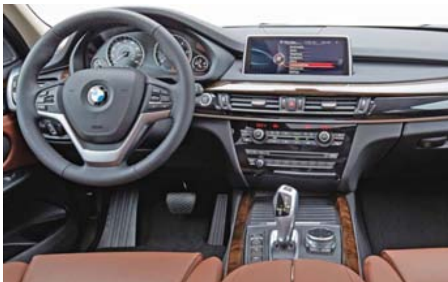
Центральная панель BMW повернута к водителю
