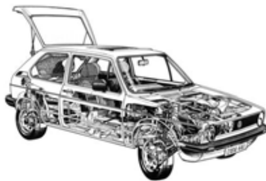
Переднеприводной хэтчбэк оснастили 1,6-литровым 110-сильным инжекторным двигателем
