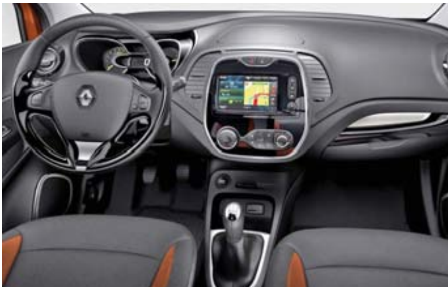
Цифровой спидометр Renault сочетается с аналоговым тахометром
