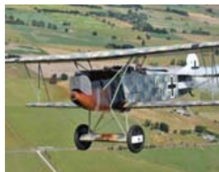
Истребитель Fokker D.VII с двигателем BMW IIIa
