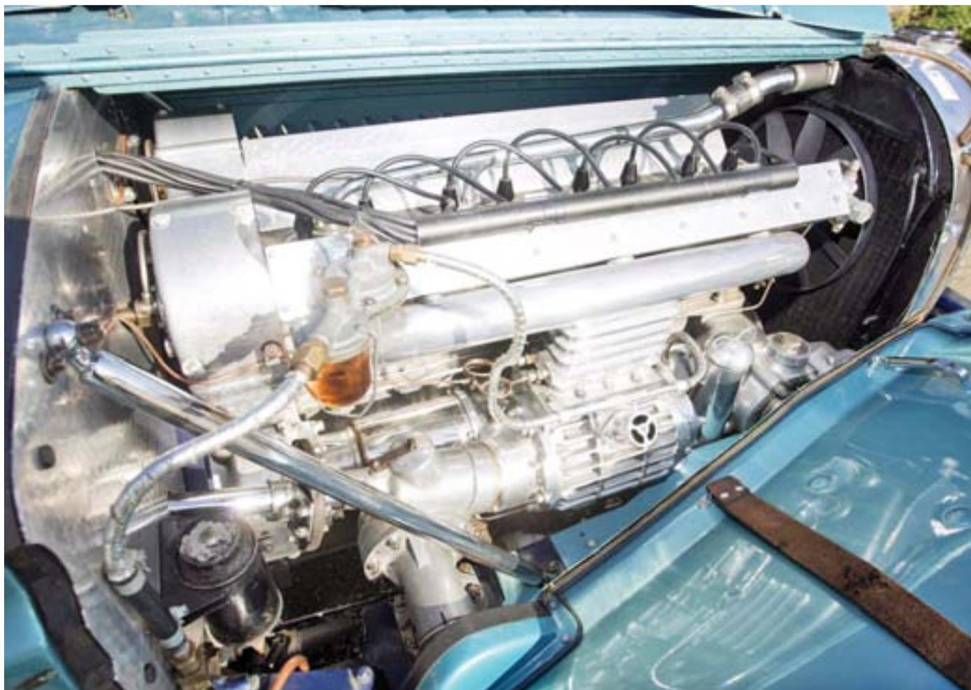
Рядную 3,3-литровую восьмерку снабдили двумя распредвалами в головке блока цилиндров
