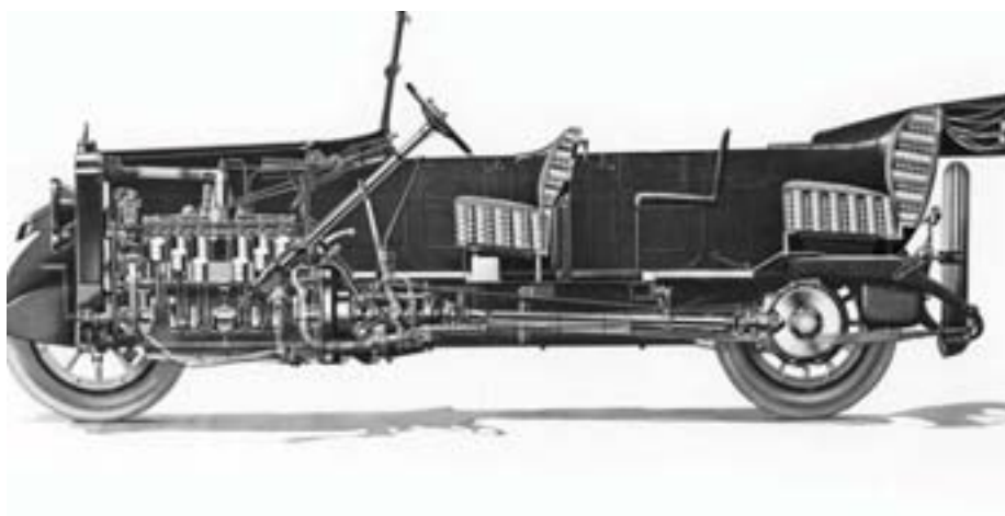
Двигатель, трансмиссия и сцепление составляли единый блок
