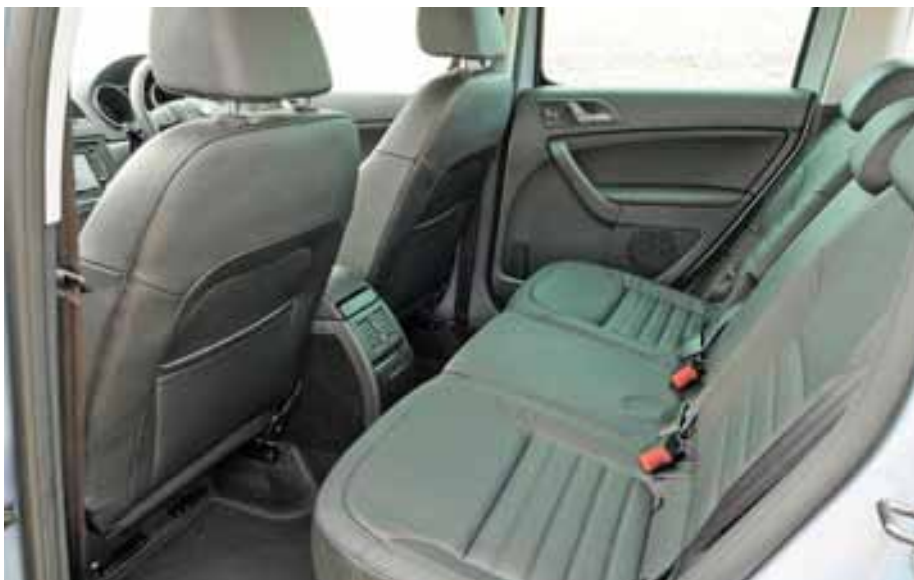
Задние сиденья Yeti оснащены горизонтальной регулировкой, изменяется и угол наклона их спинок
