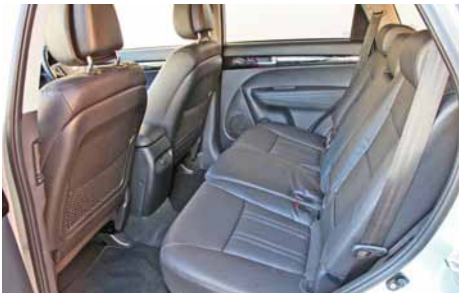
У Sorento спинки кресел оснащены регулировкой угла наклона спинок
