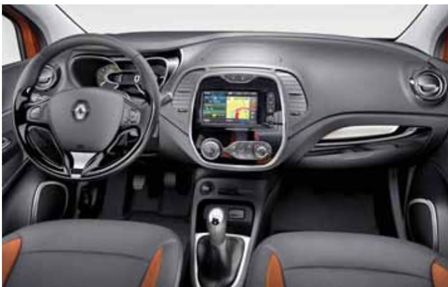
Цифровой спидометр Renault сочетается с аналоговым тахометром
