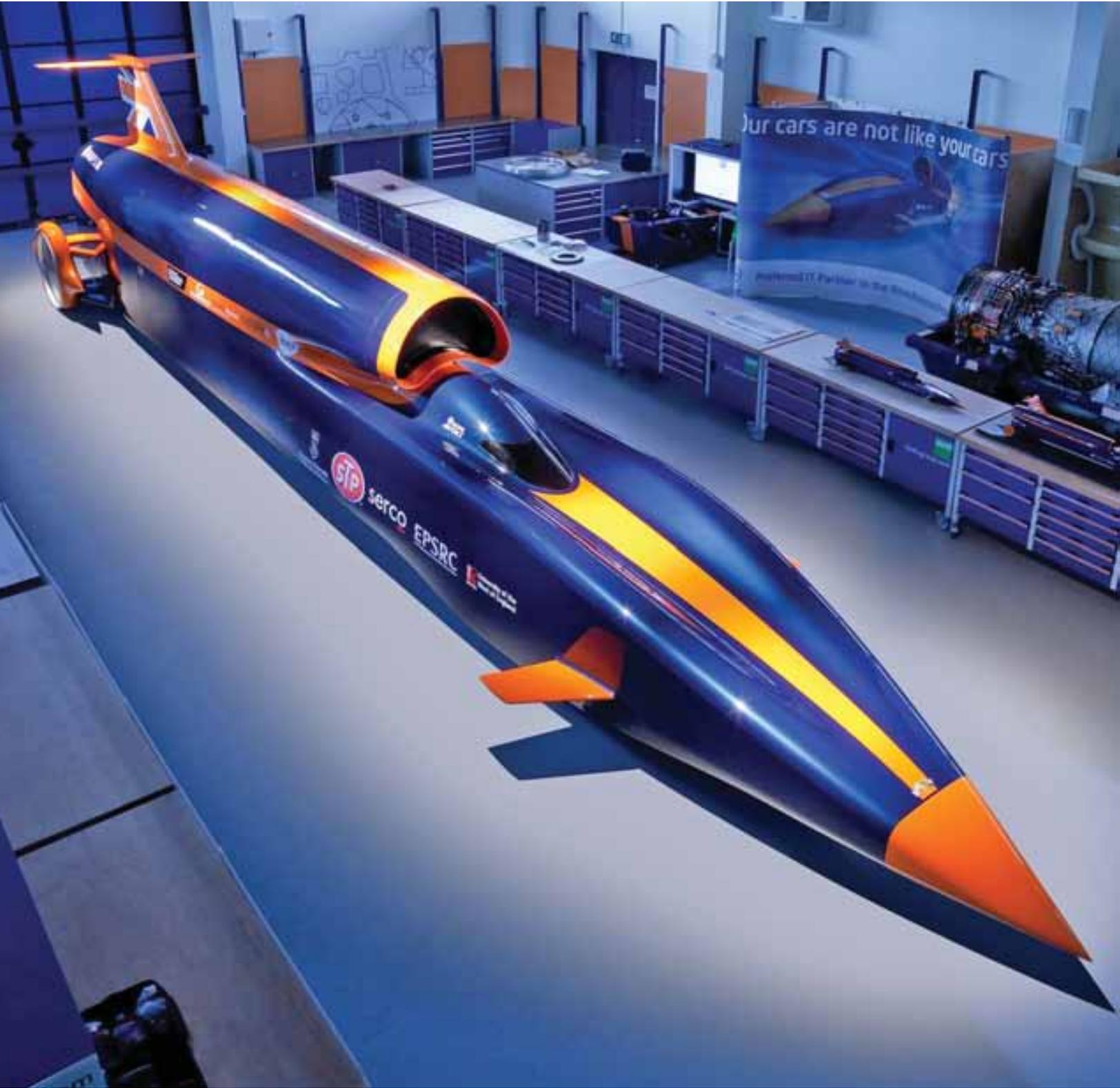
Bloodhound SSC – стреловидный болид с заостренным “носом”, как у истребителя. Его длина – целых 13,5 м. Хотя кузовные панели изготовлены из легкого карбона, его масса составляет 6,4 тонны. Колея передних колес заметно меньше, чем у задних. С самолетами автомобиль роднит и огромный киль.
