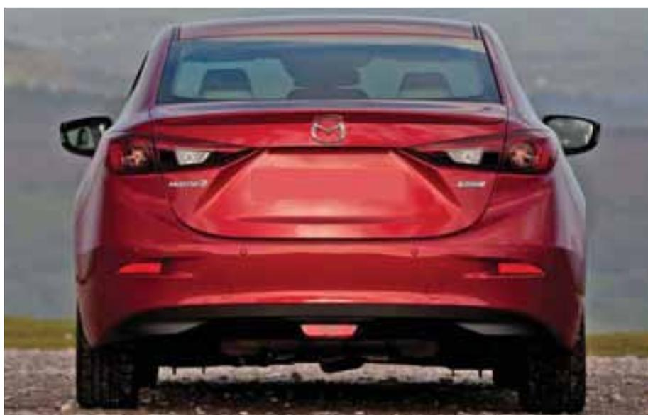
**В крышку багажника Mazda интегрирован спойлер**
