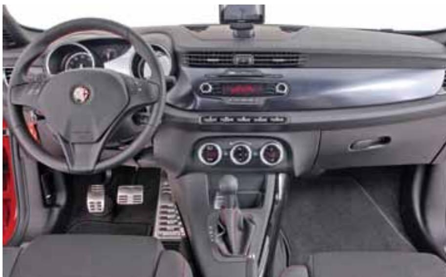
**Циферблаты приборов Alfa Romeo размещены в отдельных желобах**
