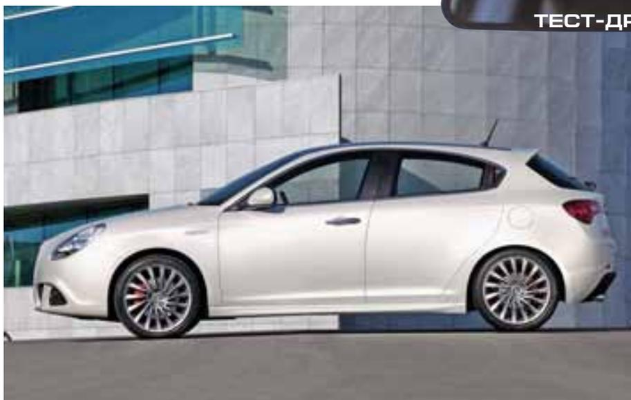
**Ручки задних дверей Alfa Romeo спрятаны в стойках**
