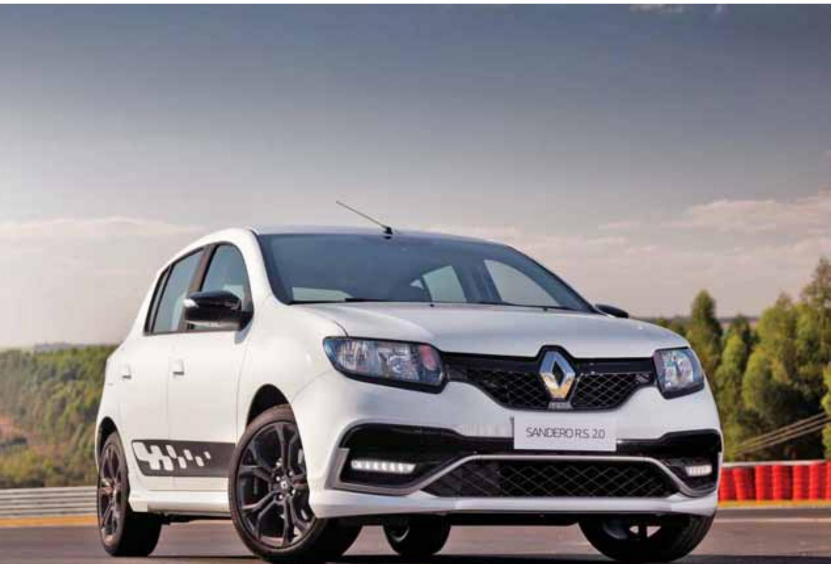
Главное отличие Renault Sandero RS – 2,0-литровая атмосферная бензиновая "четверка" мощностью 145 л. с. и максимальный крутящий момент в 190 Н•м. В паре с ней работает 6-ступенчатая механическая коробка переключения передач. Хетчбэк достигает 100 км/ч за 8 с и способен развить 202 км/ч. Двигатель эластичный и позволяет разогнаться с 80 до 120 км/ч за 5,9 с.
