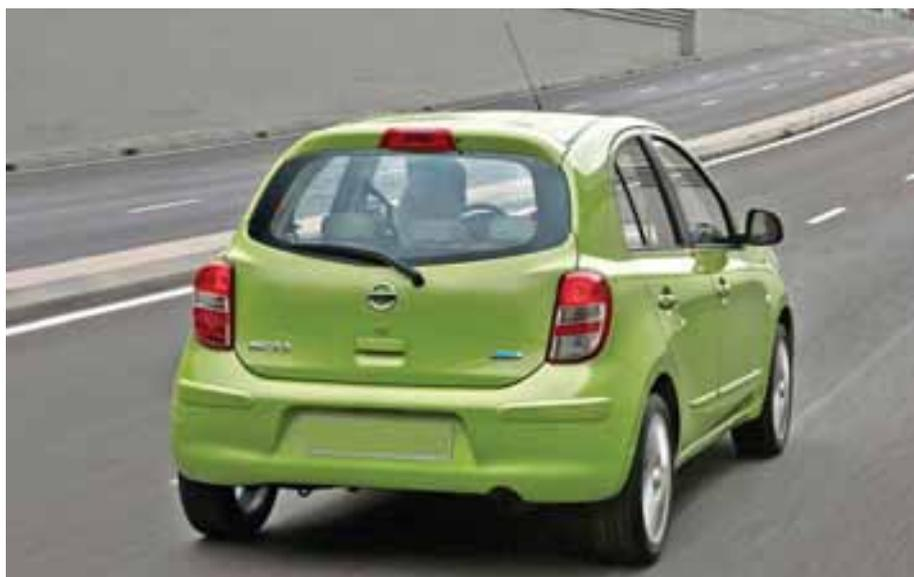
**На крыше MiRa установлен спойлер**
