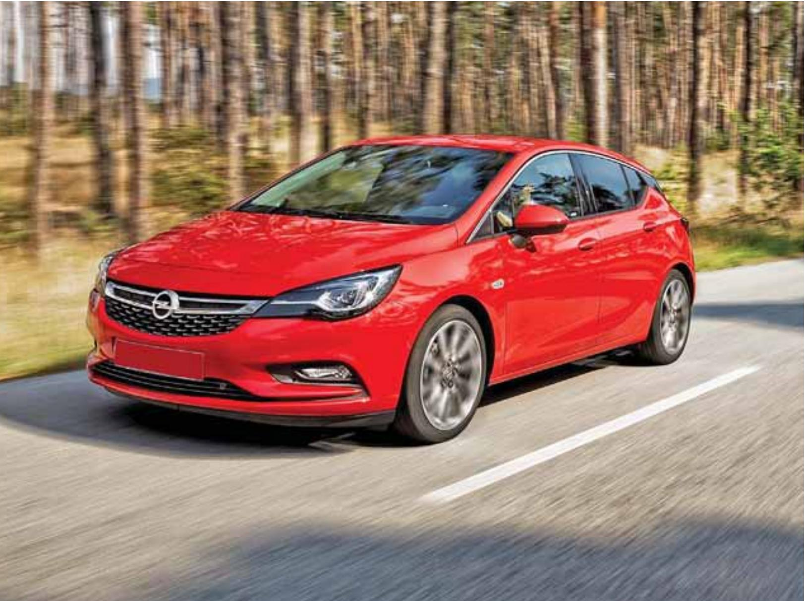
Модель радикально усовершенствовали. Для нее разработали полностью новую платформу. Astra K (такое заводское обозначение новичка) короче предшественника сразу на 50 мм (4370 мм), а колесная база уменьшена на 23 мм – до 2662 мм. Ширина осталась на прежнем уровне (1809 мм), а вот высота уменьшена сразу на 25 мм – до 1485 мм. Но главное, хэтчбек стал ощутимо легче – сразу на 200 кг, то есть 1248 кг в базовой версии. Коэффициент лобового сопротивления снижен до 0,285.
