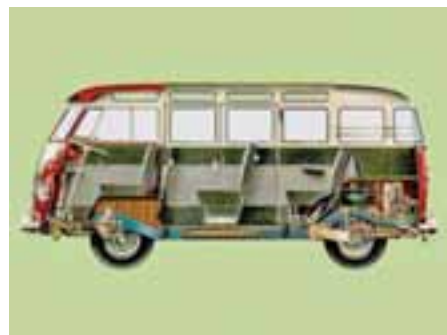
Разработчики оставили заднемоторную компоновку Volkswagen Beetle
