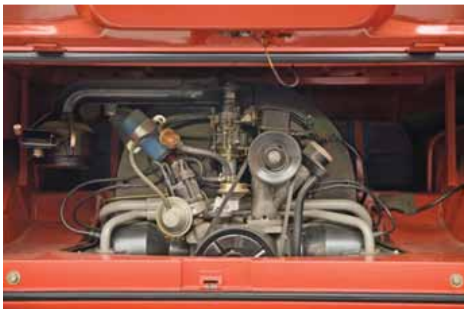
Оппозитная четверка Volkswagen T1 имела воздушное охлаждение
