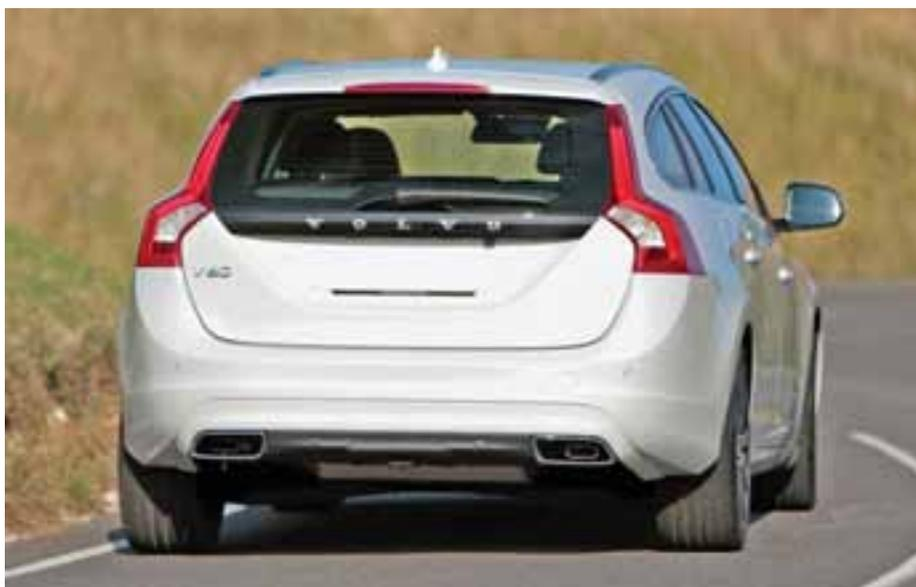
**L-образные фонари V60 размещены в стойках крыши**
