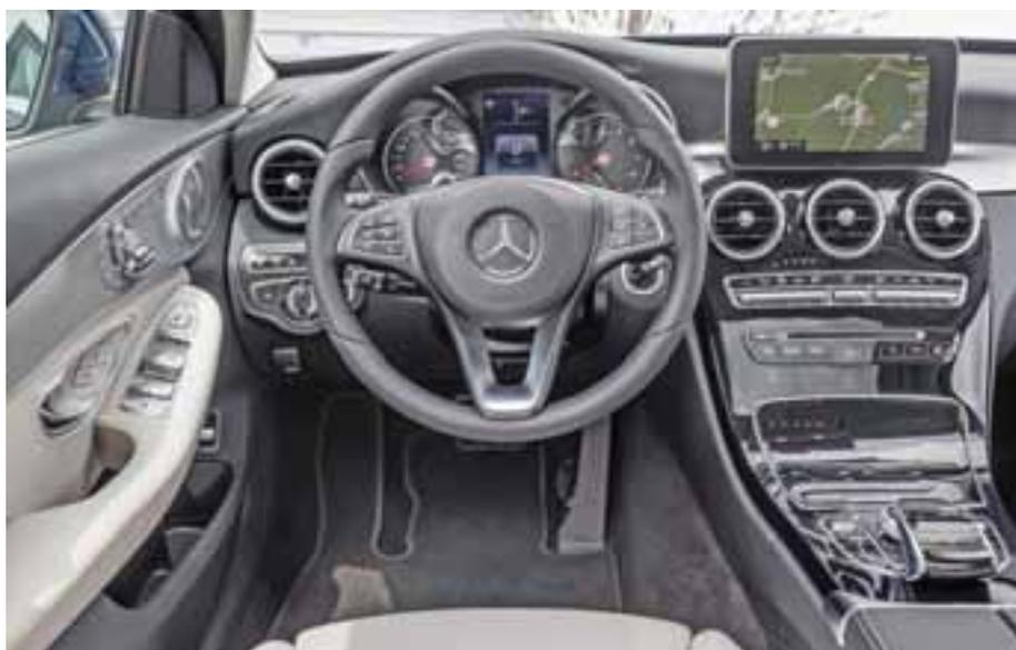
**Приборы Mercedes-Benz установлены в отдельных колодцах**
