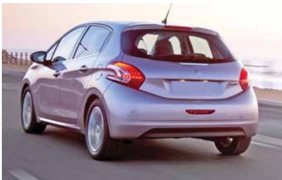
В С-образных фонарях 208 размещены светодиодные лампы
