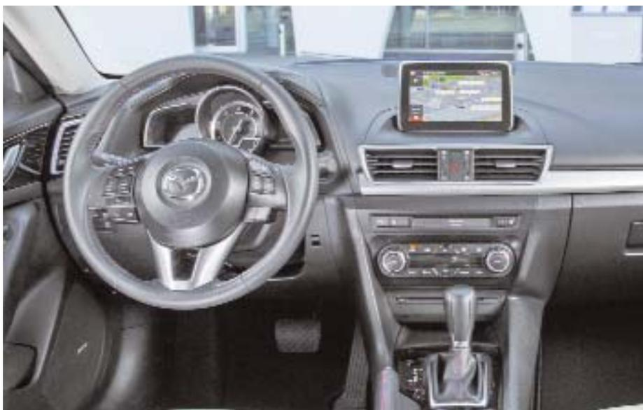
**Циферблат тахометра Mazda 3 сочетается с двумя экранами**
