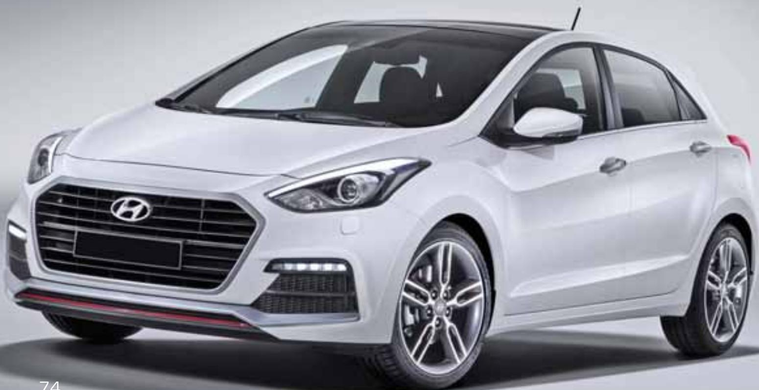
Конечно, за три года дизайн Hyundai i30 не успел устареть, поэтому внешние изменения минимальны. Прежде всего, заметна свежая трапецевидная решетка радиатора: она заметно больше, чем ранее. В бампере появились узкие светодиодные лампы дневного света. Такого же типа оптика теперь и в фарах хэтчбэка. Кроме того, отныне предложена модификация i30 Turbo с аэродинамическим обвесом, увеличенным спойлером на крыше и 18-дюймовыми легкосплавными дисками вместо стандартных 16-дюймовых.
