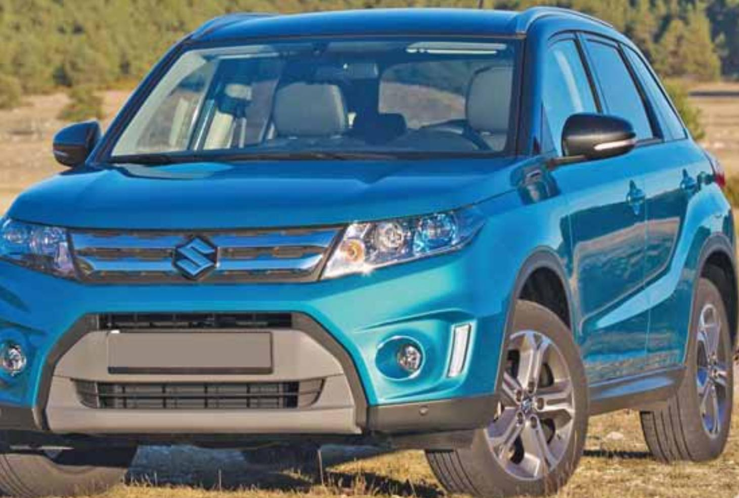
Автомобиль не позиционируют как наследника Grand Vitara, ведь он гораздо компактнее. Платформу для него позаимствовали у Suzuki SX4 S-Cross, но немного укоротили. Его длина составляет 4175 мм, а колесная база – 2500 мм. Ширина равна 1775 мм, а высота – 1610 мм. В конструкции широко применены легкие сорта стали, поэтому начальная переднеприводная версия весит всего 1075 кг.
