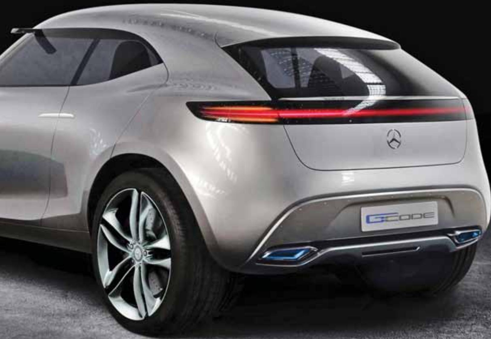
Mercedes-Benz G-Code – небольшой автомобиль. При длине в 4100 мм он на 317 мм короче самой маленькой (на данный момент) модели GLA. Но при этом автомобиль заметно шире (1900 мм) и выше – 1500 мм.
