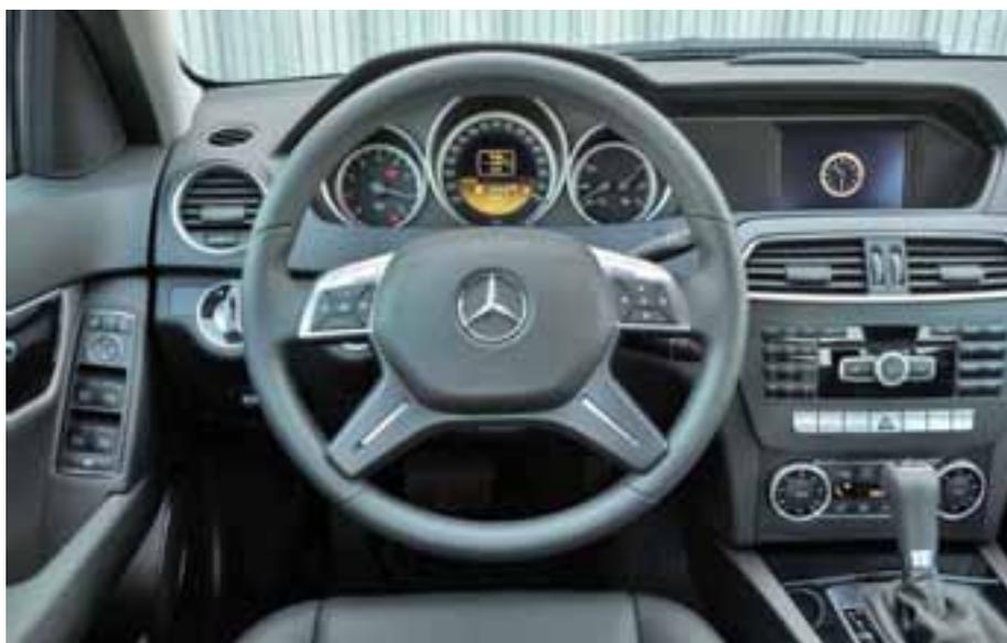
**Приборы Mercedes-Benz установлены в трех отдельных колодцах**
