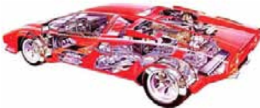
Коробку переключения передач разместили перед мотором, а карданный вал проложен через его картер
