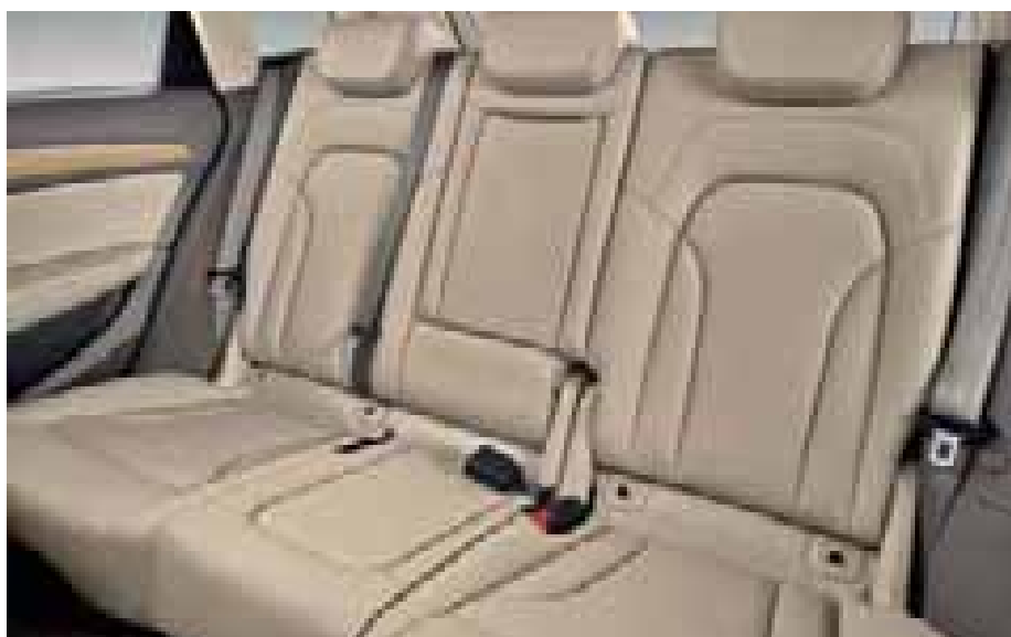
Задние сиденья Q5 оснащены горизонтальной регулировкой
