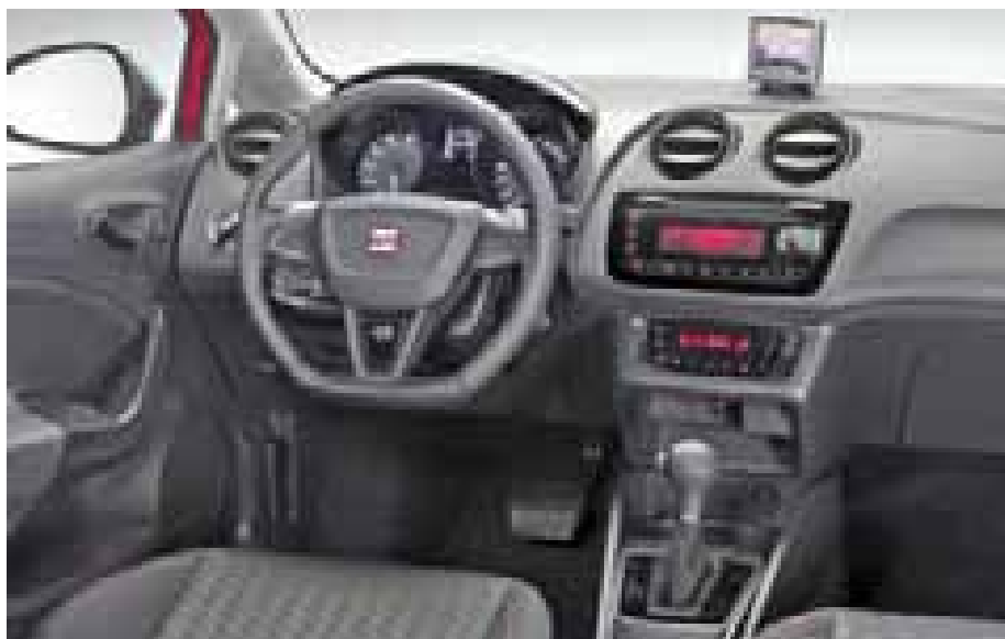
Циферблаты приборов Seat находятся в отдельных колодцах
