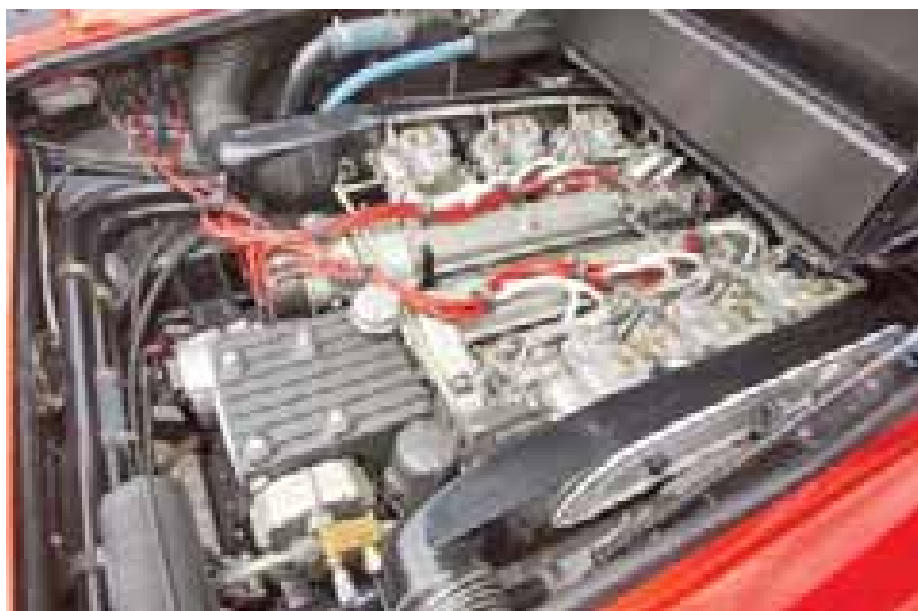
Двигатель Countach LP400 – 4,0-литровый V12 мощностью 375 л. с.
