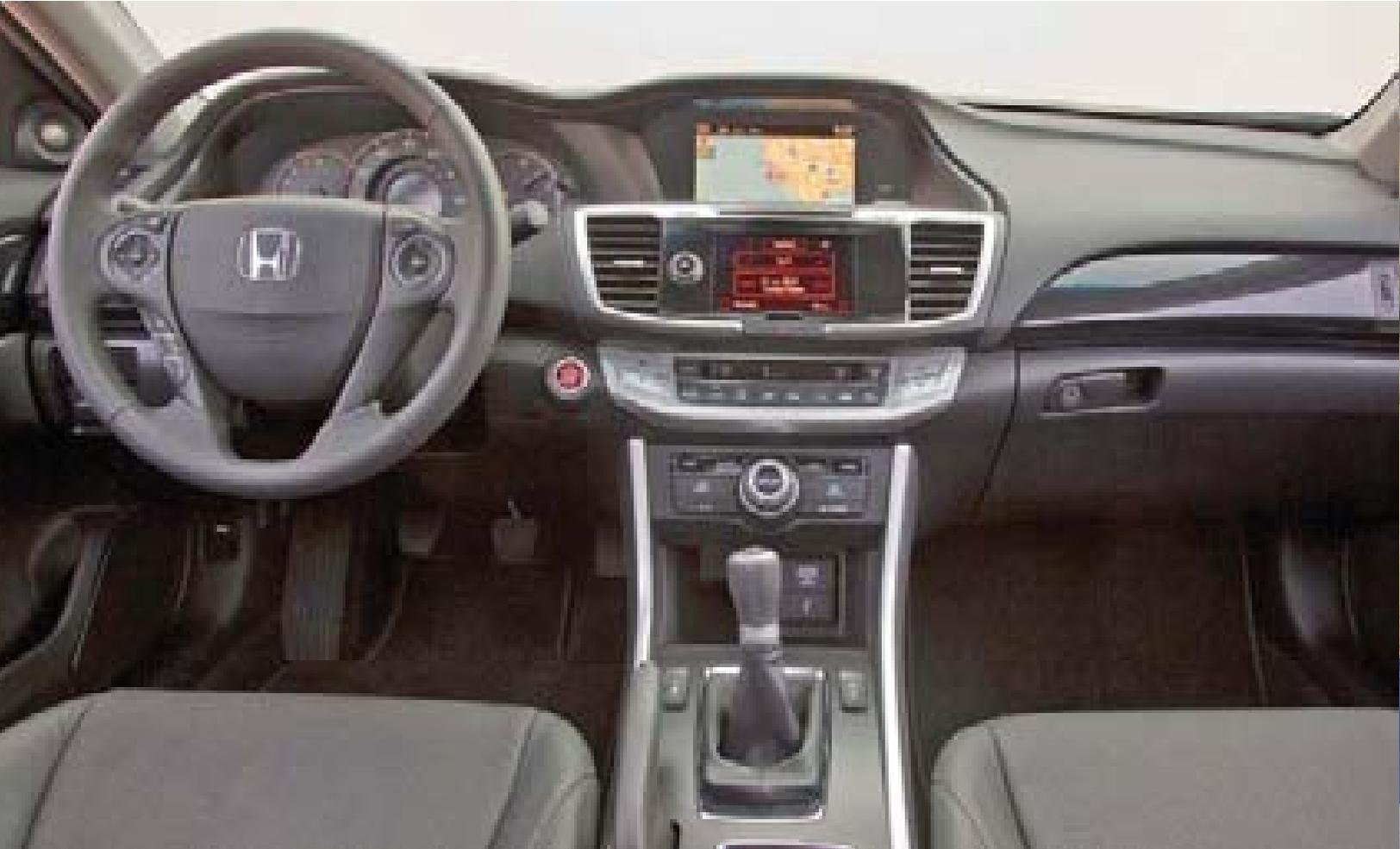
Accord Coupe оснащено электроприводом регулировок, а у рулевой колонки изменяются высота и глубина. Передние кресла широкие и мягкие, но при этом обеспечивают довольно неплохую боковую поддержку. Между ними размещен высокий трансмиссионный тоннель с двумя подстаканниками и подлокотником, прячущим вместительный бокс.
